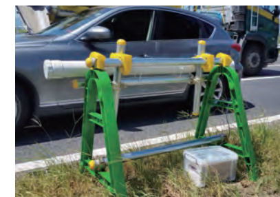
「PoST Gaugeによる交通量計測の様子」
