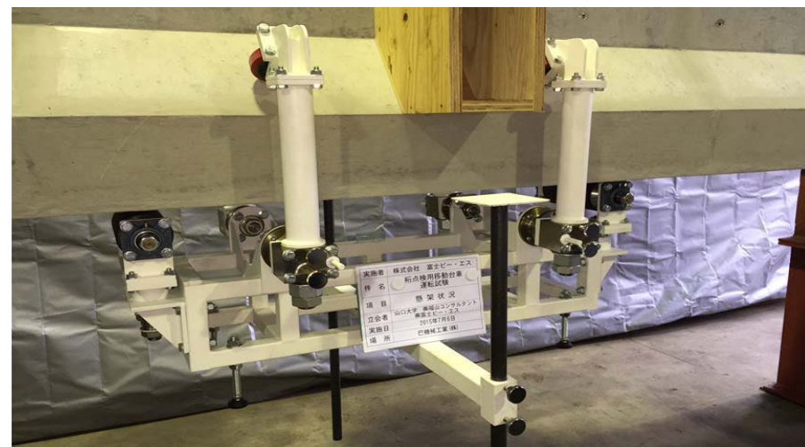
橋梁の点検ロボット(特許出願済 2016.6.22)
