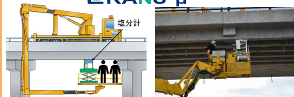
【橋梁点検車に搭載可能な中性子塩分計RANS-μ】
