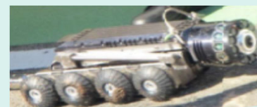
▲下水管内をカメラ計測
